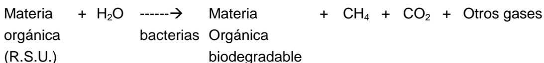
El biogás contiene entre el 50 y el 56% de metano, por lo que su poder calorífico supera generalmente las 4.400 Kcal/m<sup>3</sup>. Gracias a esta propiedad el metano tiene múltiples aplicaciones como fuente de energía y combustible.
